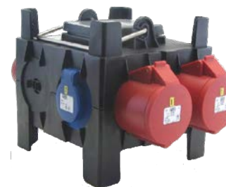
Alimentation CEE17 32A 3P+N+T 32A 4 socles 16A NF+2 socles 32TRI CEE17 protégés par un interrupteur 4X63A 30mA + 2 disjoncteurs PH/N 16A
